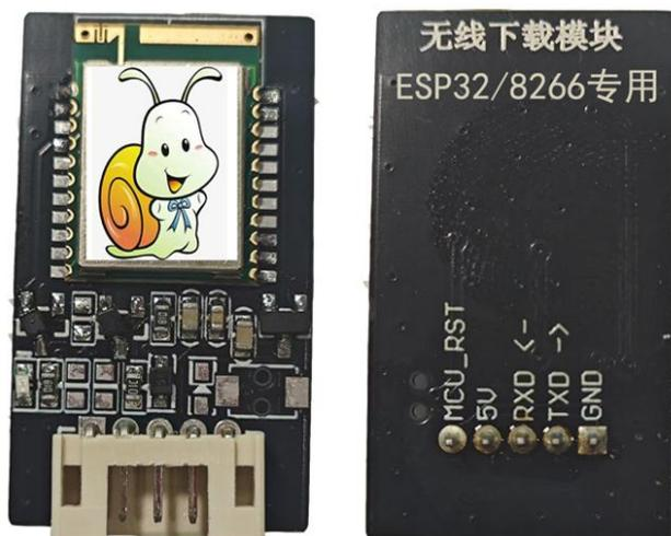
ESP 系列无线上下下载器用于 ESP8266、ESP32C3、ESP32、ESP32S3 系列开发板在 micropython 编程下的无线程序下载。
