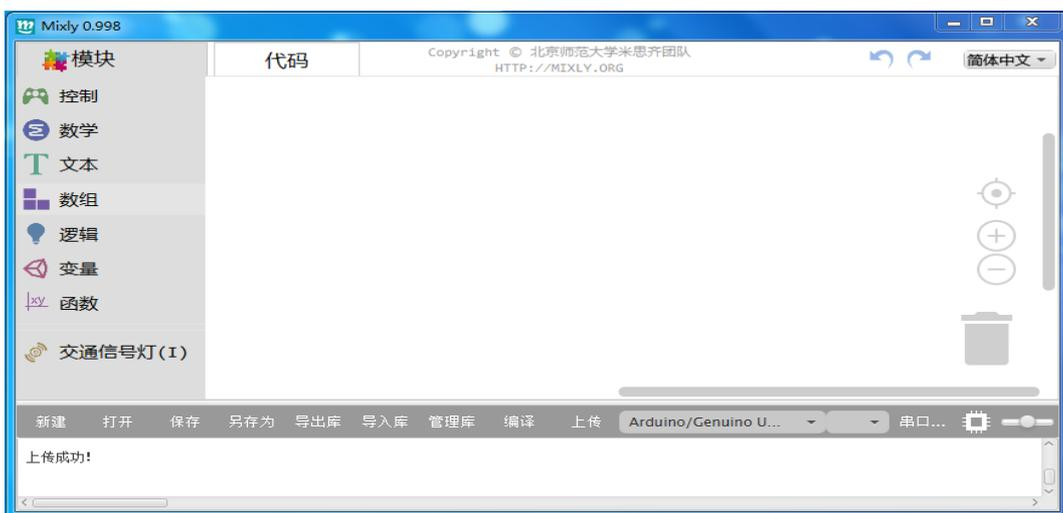
完成积木拼接编程后，点击“上传”右边的下拉框选择编程器的型号，这里统一选择“Arduino/Genuio Uno”；再点击右边第二个下拉框选择 USB 端口（第 2 节的内容有详细介绍），如下图所示。
